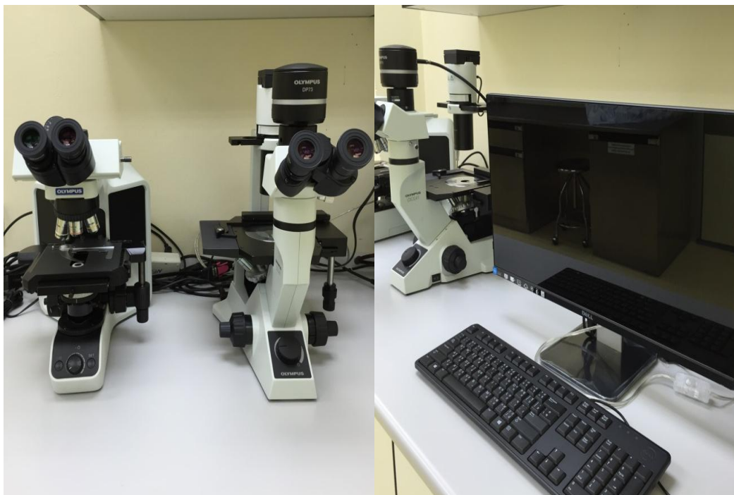
กล้องจุลทรรศน์ชนิด 3 ตาพร้อมชุดถ่ายภาพสามารถส่งสัญญาณภาพไปยังคอมพิวเตอร์ได้
