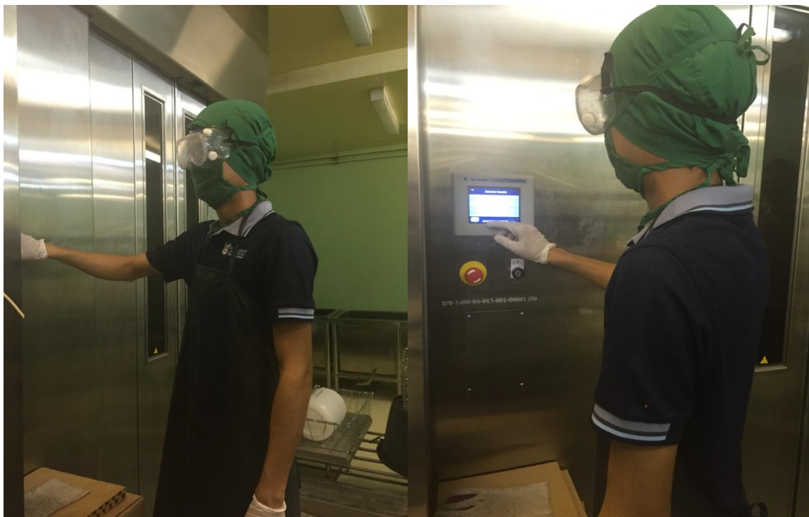
การใช้งานเครื่องล้างกรงอัตโนมัติตาม SOP และมีแผนการบำรุงรักษาตามกำหนด
