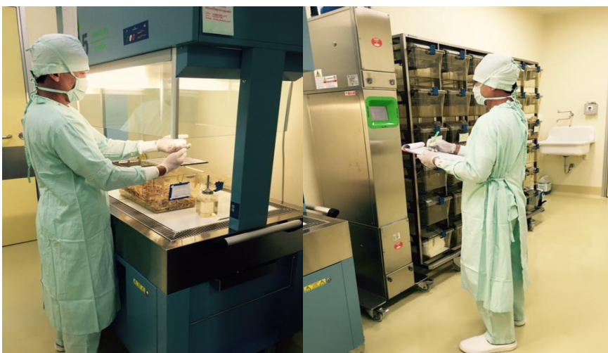
การเลี้ยงดูแลหนูไม่ซีในพื้นที่เลี้ยงสัตว์ไม่ติดเชื้อชั้น 3 ในกรง Individually Ventilated Cages, IVC
